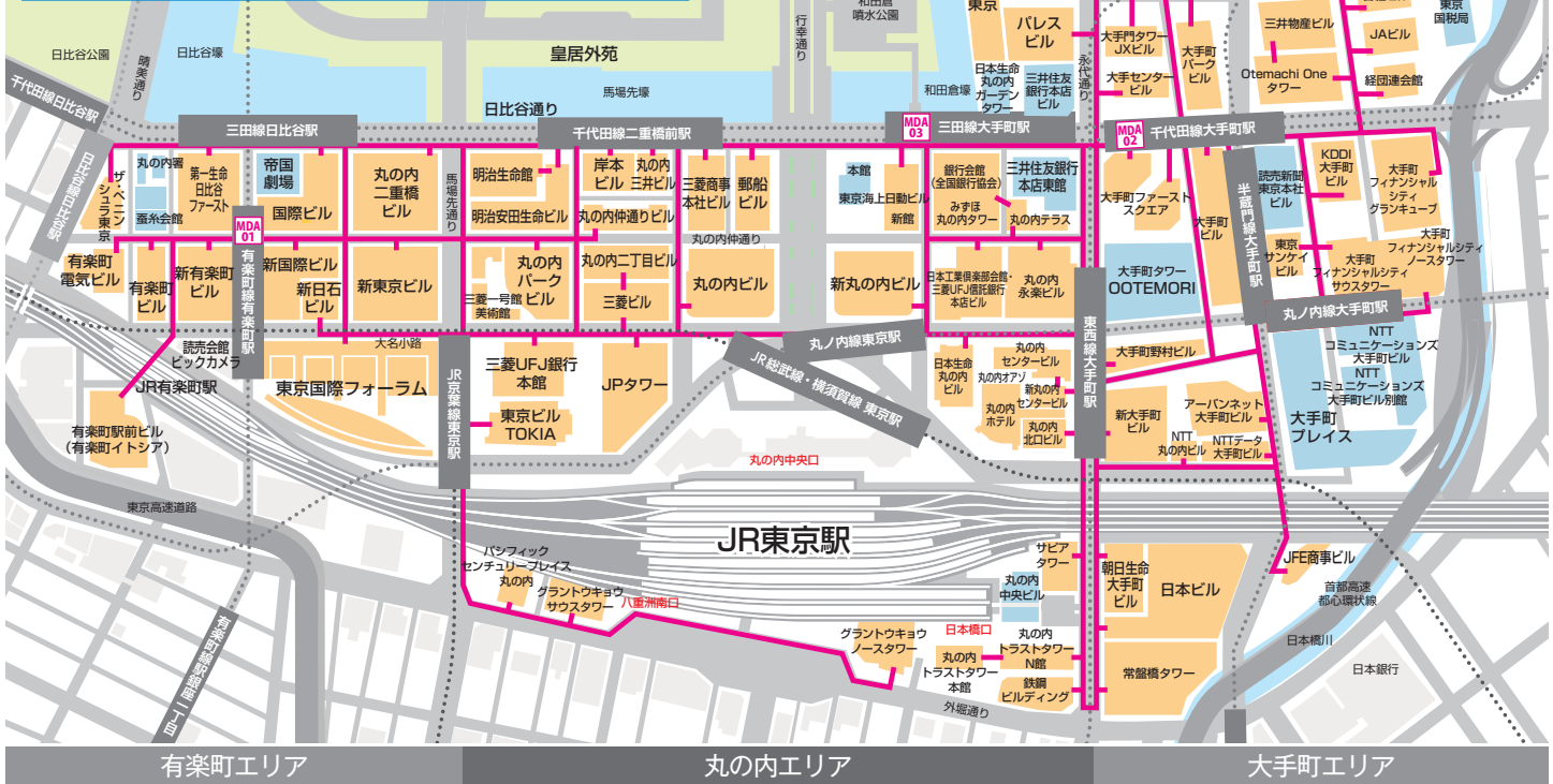
■ 光ファイバー ■ 接続ビル ■ 非接続ビル ■ 建設中ビル MDA 01 MDA 02 東京メトロ 光ネットワークと相互接続 MDA 03 都営地下鉄 光ネットワークと相互接続 2022年5月現在
