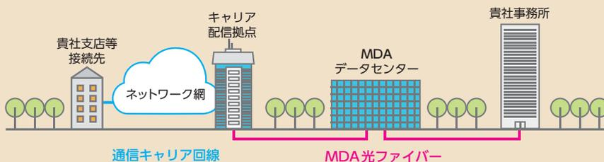
キャリアの通信回線を事務所に引き込む際に、大丸有エリア内の配信拠点から事務所まで接続ルートとして MDA の光ファイバーを利用する。
